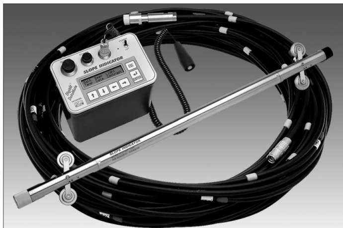
Figura 5 Sonda inclinometrica SLOPE INDICATOR
